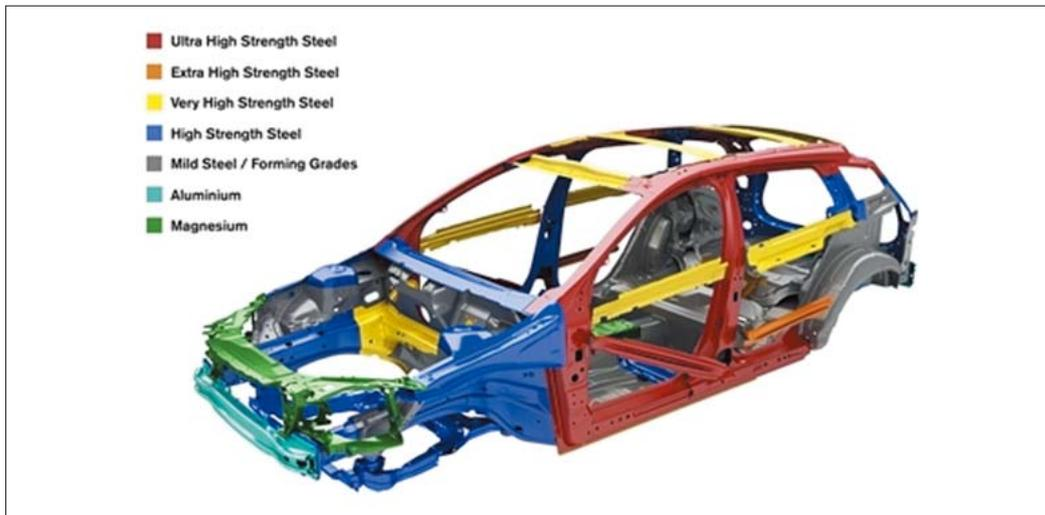
めとして有効ですが、車体修理で溶接を行う場合には、溶接部位の表面を細かく研磨する作業が必要になります。コーティングは900℃の高温に耐えられる耐熱性があり、コーティングが残った状態では、適切な溶接作業と部材同士の接合を行うことができないためです。
