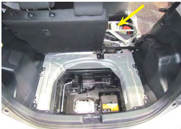
トヨタ アクアの HV バッテリー搭載位置
