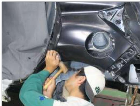
(3) 左リアフェンダ、リアパネルの溶接を行った後、3か所の切継ぎ部分の溶接を研磨してパテ仕上げし、すべての溶接作業が終了しました。
