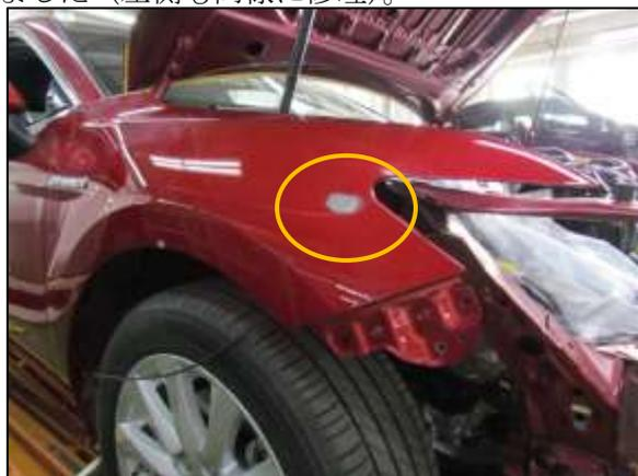
【参考】フロントフェンダは、先端部裏側にブラケットが取付いている構造です。
