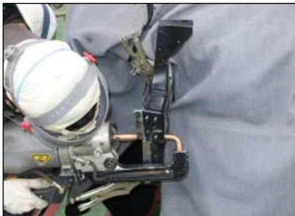
(6) 右フロントフェンダブラケットを取付後、再度外装部品を取付け、関連部品の建付けを確認して、前部骨格修理作業が完了となります。
