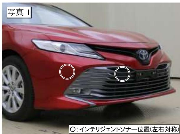
なお、インテリジェントクリアランスソナーシステム登録設定の作業方法については、自研センターニュース2016年12月号の電子機器部品等の再設定作業時間(参考値)【トヨタ プリウス 50系】を参照してください。
