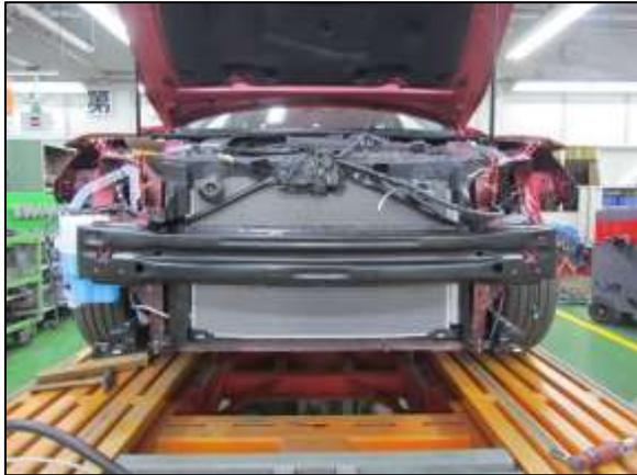
⑤溶接部品の取替作業を行う前に、クーラコンデンサとラジエータ、および一部配線配管の取外し作業を行いました。
