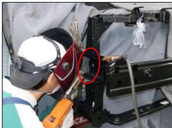
(3) 右サイドフロントメンバの半裁溶接後、ラジエータコアアツパサポートなどを取外し、半裁する右フロントサイドメンバクロージングプレートを取付けました。
