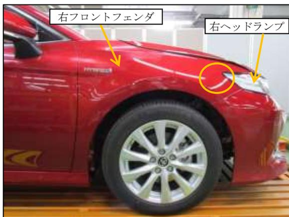
④左フロントフェンダの前部に、左ヘッドランプの押込みによる僅かな歪みが発生しています。
