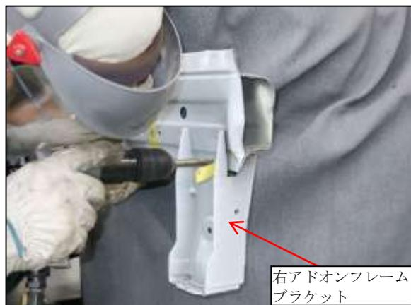
(3) 修理書に従って、右フロントサイドメンバクロージングプレートに赤線（半裁位置）より右側で半裁するため、スポット溶接を取外しました。
