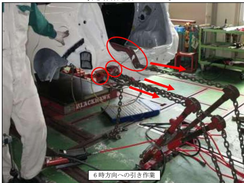
② 寸法復元作業により、リアフロントフロアの損傷が修復できました。
