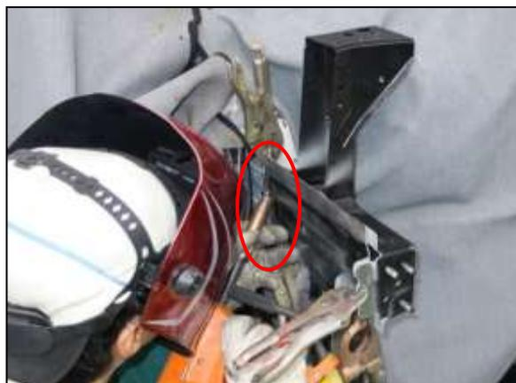
(5) 右ラジエータコアサイドサポート、右アドオンフレームブラケット、右フロントサイドメンバクロージングプレートをスポット溶接しました。
