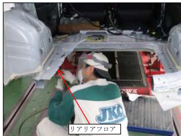
(3) 粗切り後に残ったリアパネル、リアリアフロア、サイドメンバリアエクステンションの溶接点をドリルでもみ取外しました。
