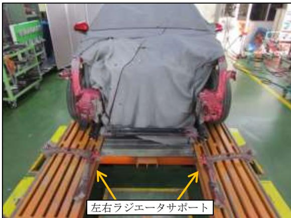
②補給部品の左右ラジエータサポートをボデーにクランプで仮止めし、計測器具とボデー寸法図を使用して正しい位置に合せました。
