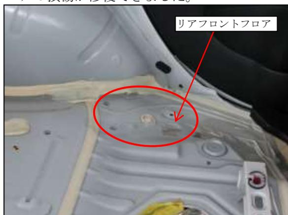
③ 寸法復元作業により、リアインナホイールハウスの損傷が大幅に減少しました。
