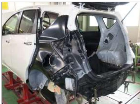
(2) 左リアフェンダに接着剤を塗布し、リアフェンダを数か所溶接して仮止めした後、接着剤が硬化しない間にハンマーとドリルを用いてアーチヘミング部を折り返しました。
