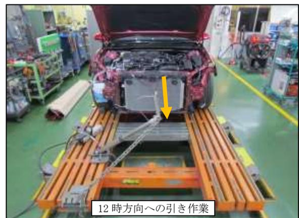
④引き作業により修正した左右フロントサイドメンバの位置を、計測とバンパラインホースメントの取付けにより確認しました。
