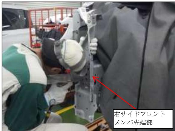
(2) 右フードレッジの寸法修正が完了したので、右フードレッジレインフォースメントを取外します。
