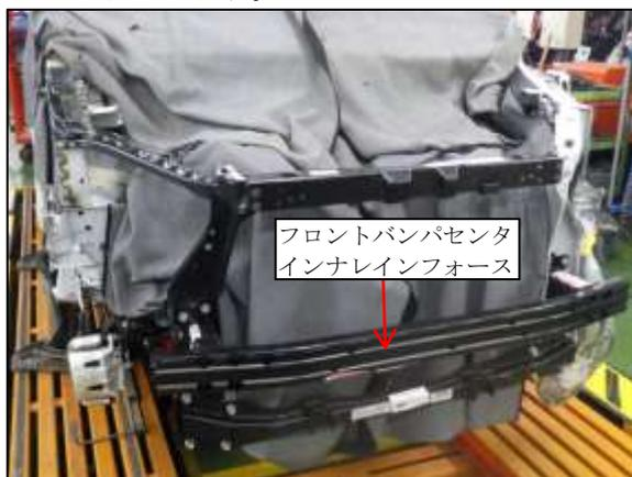
(6) 外装部品を取付け、関連部品の建付けを確認します。
