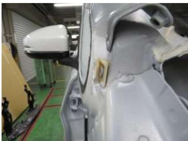
赤矢印のようにフロントフェンダパネル上部の突起部をフロントフェンダクリップに差込む構造です。
