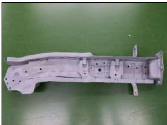
(2) フロントバルクヘッドなどの関連部品を取付けて計測しながら、右サイドフレームの取付位置を合わせました。
