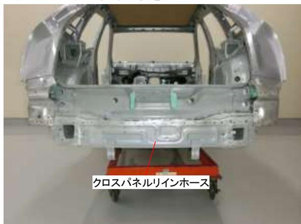
リヤクロスパネル、クロスパネルラインホース取外し状態
