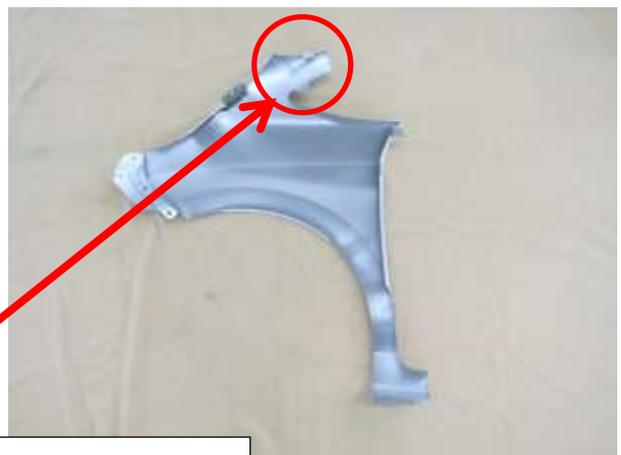
丸印部がボルトにより締結される
