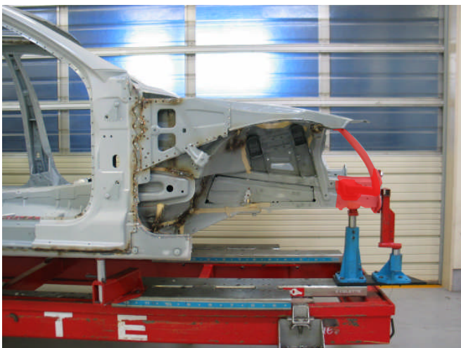
【片側ホイールハウスコネクション、片側フロントセクションリペアサイドメンバ半裁取替】
