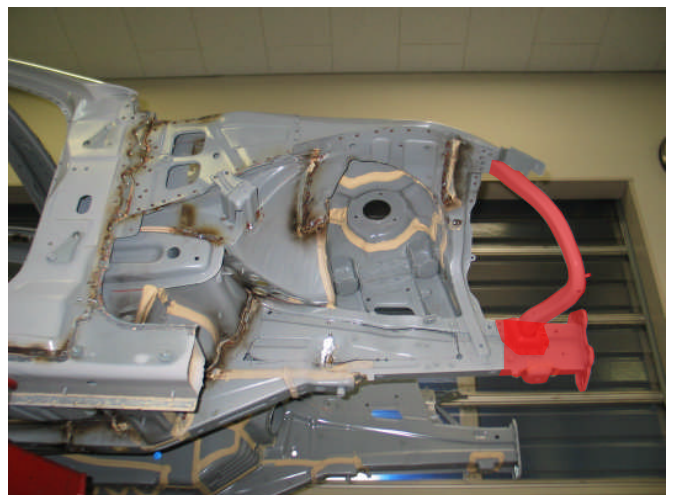
【片側ホイールハウスコネクション、片側フロントセクションリペアサイドメンバ半裁取替】
