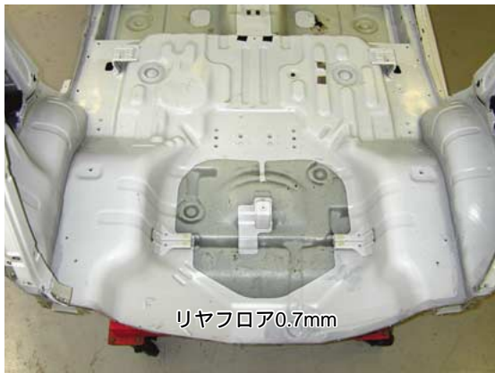
リヤ上側（リヤフロア取付状態）
